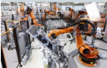
Automatisierte Fertigung von Solarmodulen (Bild: KUKA Systems GmbH).
